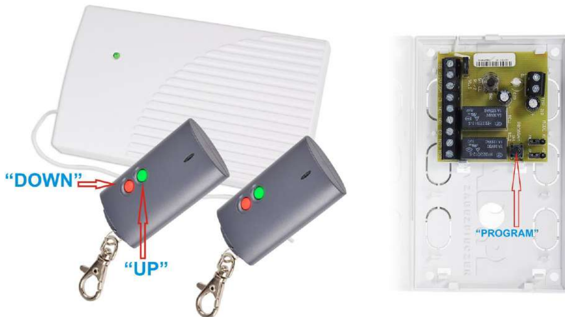
Рис. 8. Контролер радиоуправления Satel RE-2K и радеобрелоки Satel T-2.
