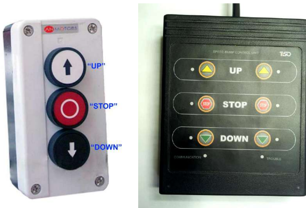
Рис. 11. Обычный стационарный кнопочный пульт управления (слева) и 6-ти кнопочный пульт управления AUIA111 (справа).
