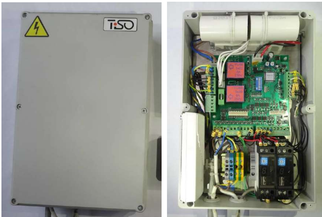
Рис. 1. Блок управления блокиратором с внутренней минигидростанцией.
